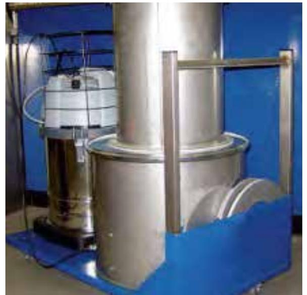
Système de nettoyage du filtre TFC-500
